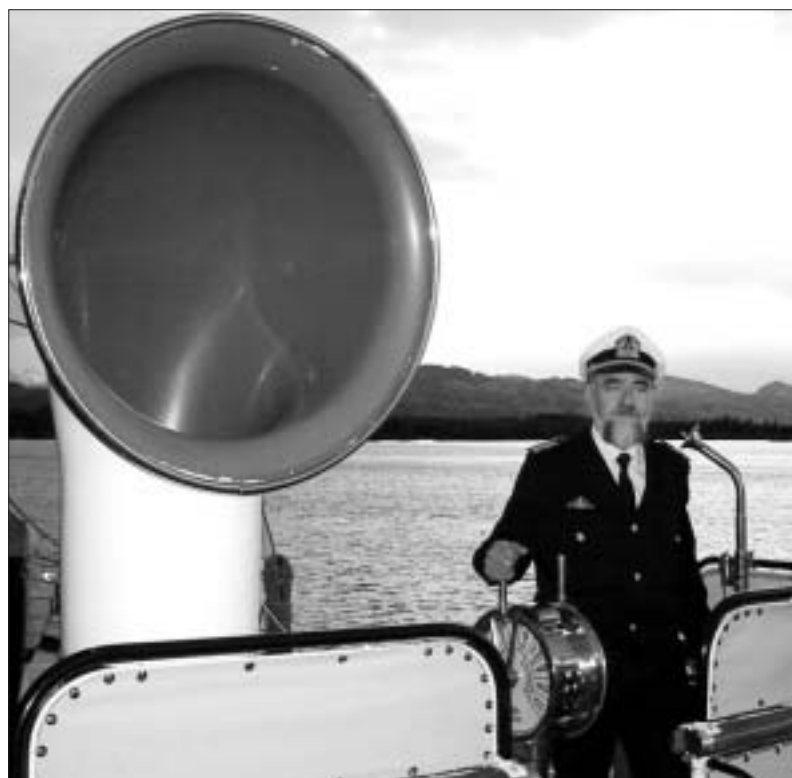
Kapitän Kloser auf der Kommandobrücke der „Hohentwiel“. Links eine Windhutzte, über die der Maschinenraum des Schauflerraddampfers belüftet wird. SZ-Foto: Hildegard Nagler
